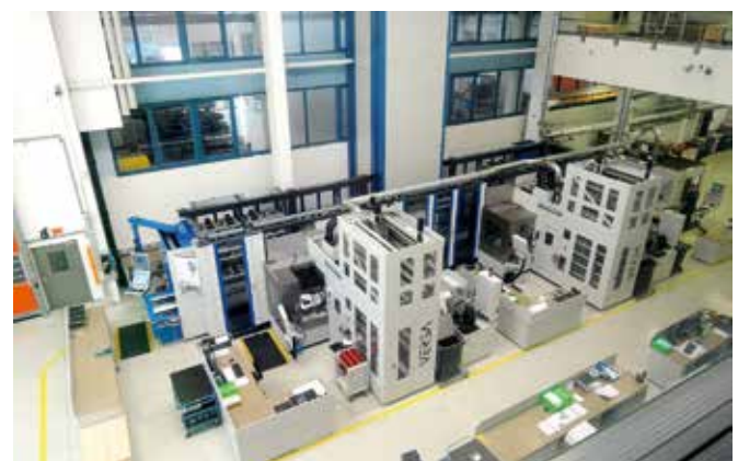
Die Bearbeitungszentren von Fehlmann lassen sich in Firmennetzwerke einbinden, zum Beispiel als Teil einer größeren Fertigungsstraße.
