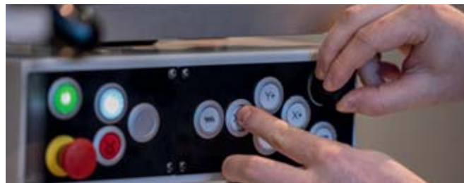
Handbediente Maschine mit Motortisch und Positip 8000 Active: So ersetzt die Fehlmann Picomax 21-M einfache CNC Maschinen.
