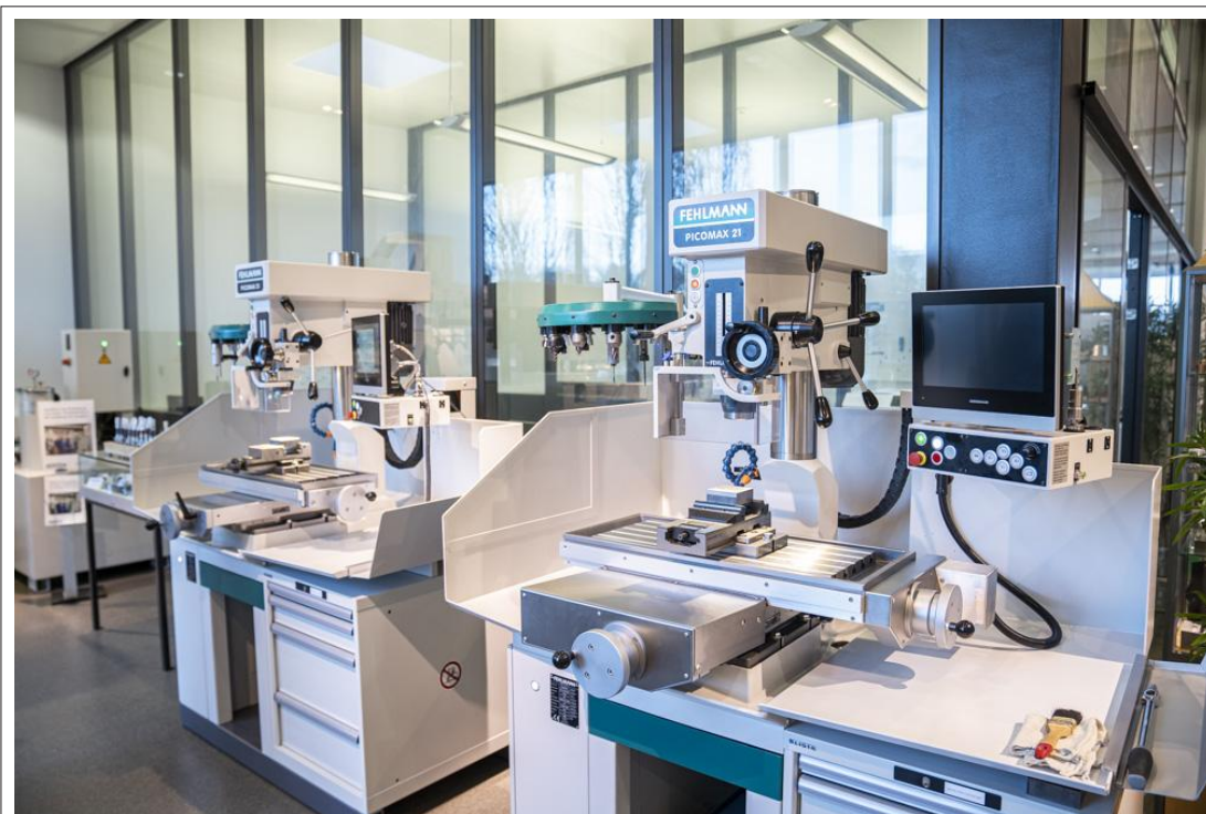
Handbediente Maschine mit Motortisch und Positip 8000 Active: So ersetzt die Fehlmann Picomax 21-M einfache CNC Maschinen.
