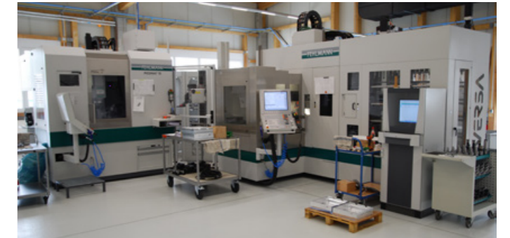
FEHLMANN VERSA 825 und PICOMAX 75 mit Erowa Robot Dynamic, FEHLMANN MCM™
