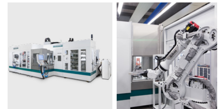
Knickarmroboter Gibas und Jobmanagementsystem Soflex an VERSA 825
