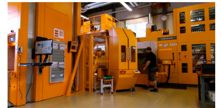
Knickarmroboter und Goodj-Automationsystem an FEHLMANN VERSA 825 mit Regalmagazin für 346 Werkzeuge
