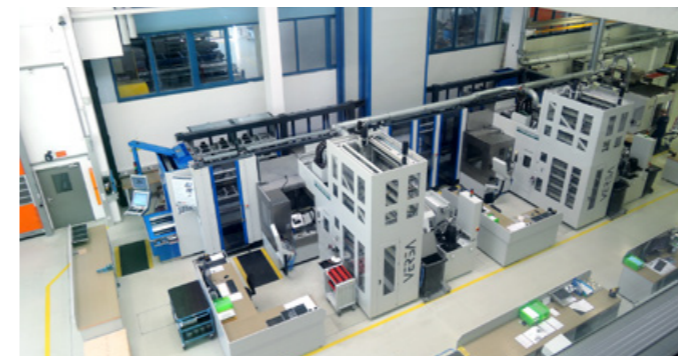
Lineare Automationslösung aus zwei FEHLMANN VERSA 825 mit Regalmagazinen für je bis 346 Werkzeuge
