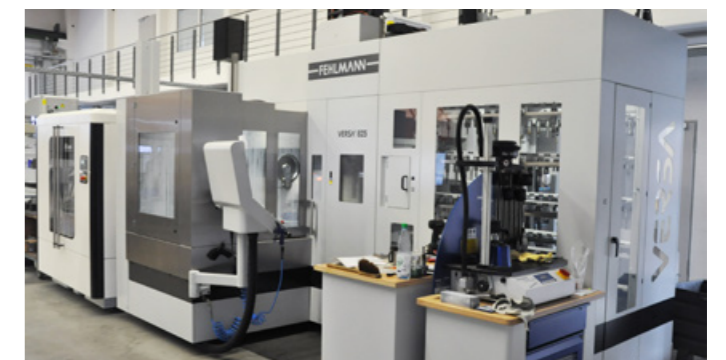
LANG ECO Compact 20 an VERSA 825, Ansteuerung über M-Funktion
