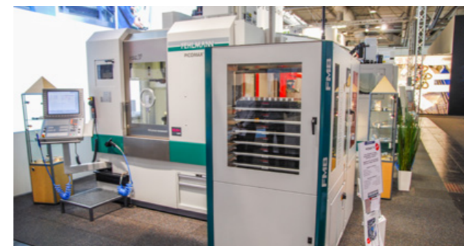
Knickarmroboter FMB für Rohteilehandling an FEHLMANN PICOMAX 75
