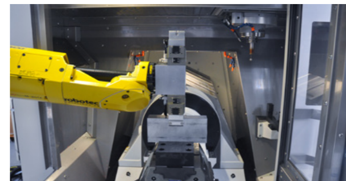
Knickarmroboter für Paletten- und Rohteilehandling an FEHLMANN VERSA 825
