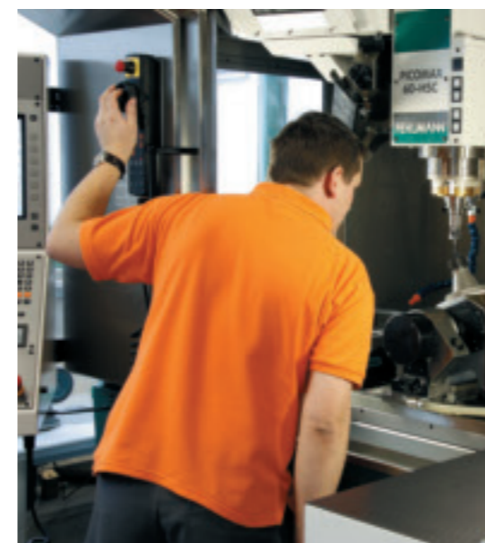
Wichtiges Merkmal der FEHLMANN PICOMAX 60-HSC ist die gute Zugänglichkeit zum Maschinenraum und dass auf der Maschine gleichzeitig ein Schraubstock und ein Teil-Schwenkapparat als 4. und 5. Achse aufgebaut werden können.
