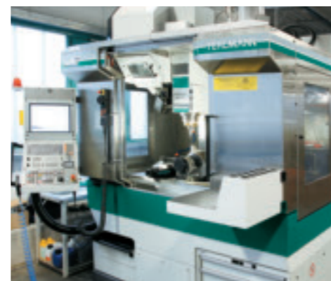
Durch die Anschaffung eines 5-Achs-Bearbeitungszentrums FEHLMANN PICOMAX 60-HSC konnte die Schlagkraft und Präzision im Prototypenbau bei der Firma W&H Dentalwerk Bürmoos GmbH weiter erhöht werden.
